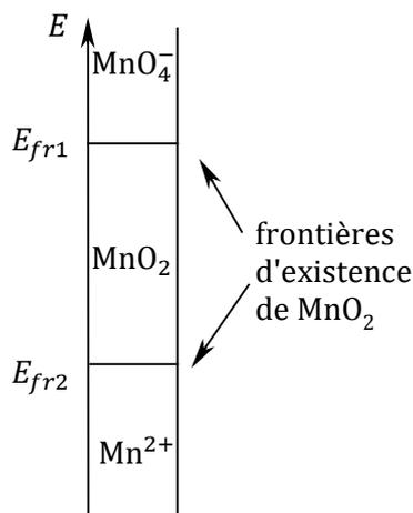
Pour tracer un diagramme de stabilité et calculer précisément les frontières, il faut définir une **concentration de tracé**. Par définition, il s'agit de la concentration totale en manganèse dissous, lorsque la solution est limpide (absence de solide  $\text{MnO}_2$ ). Comme il y a deux espèces du manganèse en solution, on a, en dehors du domaine d'existence de  $\text{MnO}_2$  (pour  $E \geq E_{fr1}$  et pour  $E \leq E_{fr2}$ ) :
